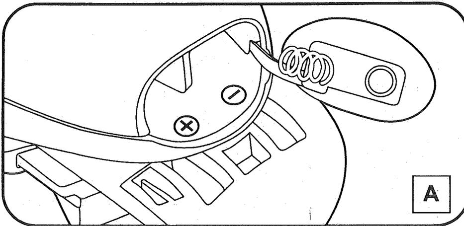
1. Schieben Sie die Batteriefach-Abdeckung in Pfeilrichtung (auf dem Gehäusedeckel abgebildet) und nehmen Sie diese ab.
