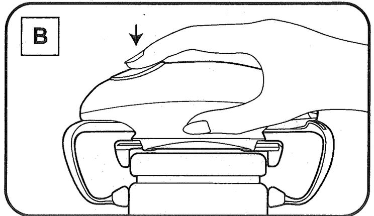
3. Drücken Sie den Startknopf (1) ca. 3 Sek. bis sich die inneren Klemmbacken (4) bewegen. Die äußeren Klemmbacken (5) werden sich soweit nach innen bewegen, bis sie das Glas sicher halten. Die inneren Klemmbacken rotieren und haften am Deckel. Sie öffnen dabei den Deckel.
