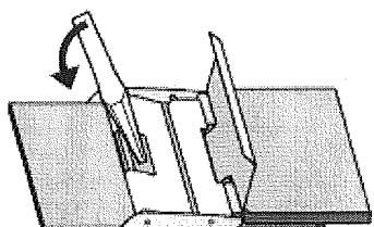
2. Klappe mit einem kleinen Werkzeug wie z.B. einem Schraubenzieher gemäß Abbildung aufhebeln.
