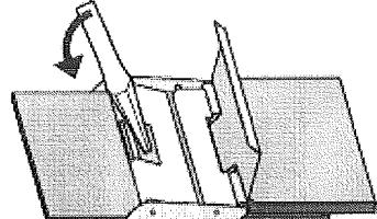
2. Plaats een klein stuk gereedschap, zoals een schroevendraaier in het slot om de bar omhoog te halen, zoals aangetoond op de afbeelding.
