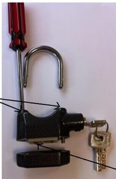
Trekk ut skruene når du skal bytte batterier.
