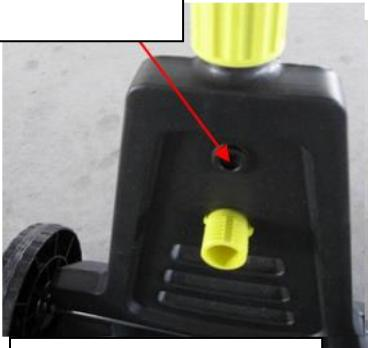
Etape 4: Insérer l'écrou et visser la vis par l'arrière à travers le trou prévu dans le tube.
