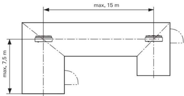
Dans les locaux ou couloirs en L, les détecteurs de fumée devraient être installés sur les lignes d'onglet.
