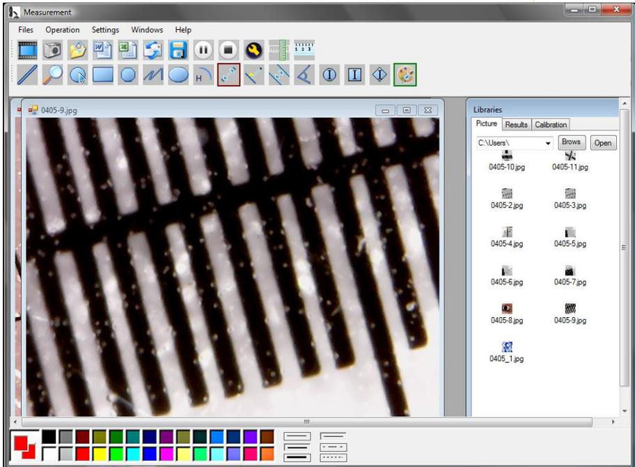
4. Utilisez la fonction de mesure de distance
