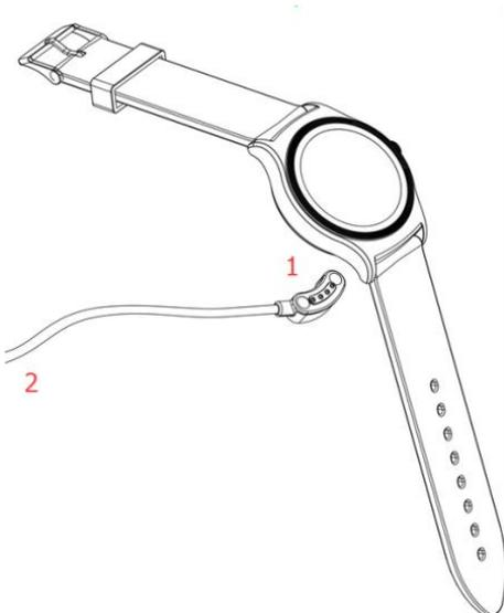
1. Stellen Sie sicher, dass die POGO-Pins der Lade Kabel richtig auf die Ladepole auf der Rückseite der Smartwatch passen.
