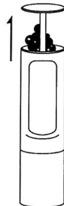
4. Drücken Sie den oberen Teil um die Kappe herauszuziehen, entfernen Sie die Haare und Fussel.
