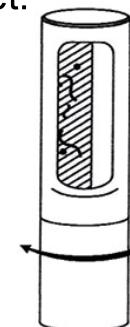
3. Drehen Sie den Griff 2-3 Mal, um die Bürste zu reinigen.
