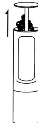
4. Appuyez sur la partie supérieure pour retirer le bouchon, enlever les cheveux et les peluches.
