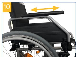
Pour escamoter l'accoudoir vers l'arrière, actionner le levier de déverrouillage qui se trouve à l'avant de l'accoudoir et le maintenir enfoncé tout en tirant l'accoudoir vers le haut, jusqu'à ce qu'il soit libéré. L'accoudoir peut alors être repoussé vers l'arrière (fig. 11+12).
