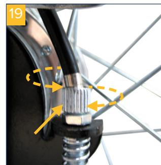
Pour régler le frein, commencer par desserrer le contre-écrou, puis serrer ou desserrer la vis de réglage. Cela fait, ne pas oublier de resserrer le contre-écrou en maintenant la vis de réglage au moyen d'une pince. Si le fauteuil roulant est manœuvré par un auxiliaire : pour freiner, presser les deux poignées de frein contre les poignées du fauteuil.
