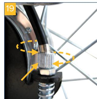
Per la regolazione, svitare il controdado ed eseguire la regolazione desiderata, quindi stringerlo nuovamente, tenendo ferma contemporaneamente la vite di regolazione con una pinza. Per frenare la carrozzella, l'accompagnatore deve tirare verso di sé le due manopole del freno.
