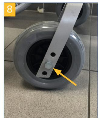
De afsluitingen van de verschillende openingen zijn gemakkelijk te verwisselen. Zet het wiel nu in de gewenste positie, breng de schroef van de wielas weer aan en draai deze vast (**afb. 8**).
